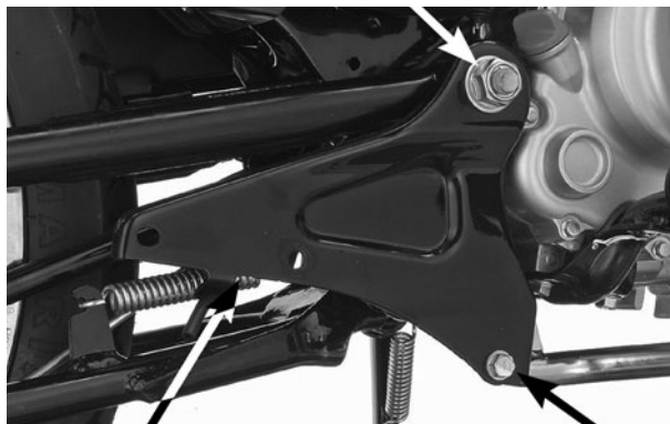
SUPOORTE DO SILENCIOSO PARAFUSO DE FIXAÇÃO PINO DE CONEXÃO MOLAS
